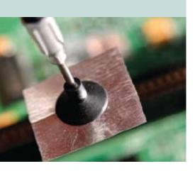
этих сплавов и, что самое важное, необходимо подобрать флюс, который должен хорошо устранять онсиды с поверхности нинеля/титана и обязательно полностью удаляться в процессе отмывки. Подобные задачи требуют экспериментального поисна подходящего сплава и отработки технологии его использования.
